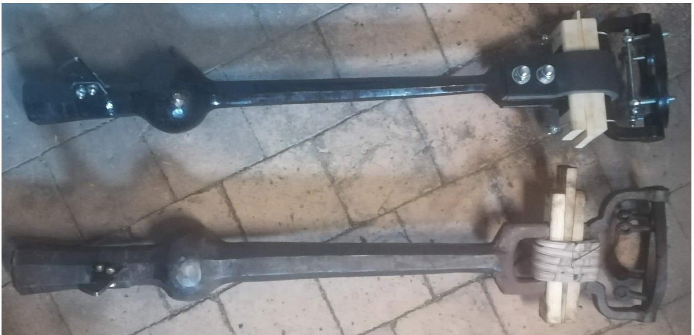
Bild: Vergleich der beiden Klöppel; der neue Klöppel ist oberhalb im Bild
